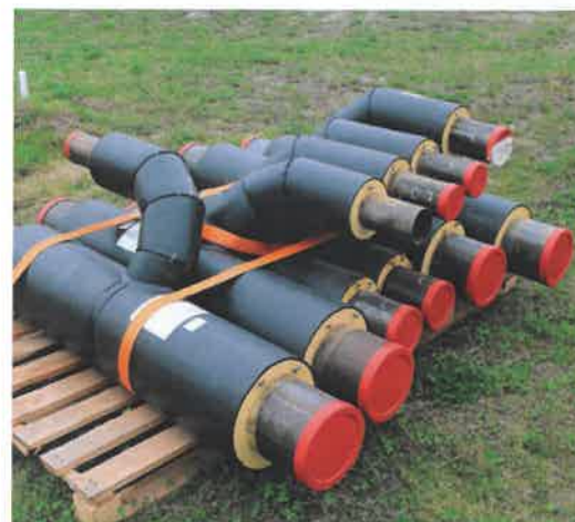
耐火被覆された配管材料
